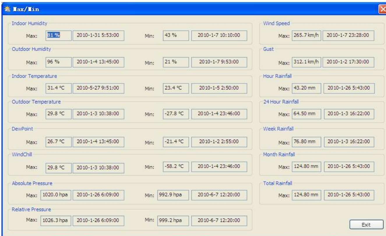
Dieser Bereich wird verwendet, um die aufgezeichneten MAX und MIN Werte mit einem Zeitstempel zu versehen. Die MAX und MIN Werte können nur am Hauptgerät zurückgesetzt werden.
